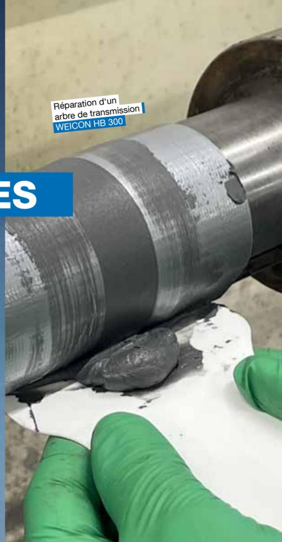
Réparation d'un arbre de transmission
