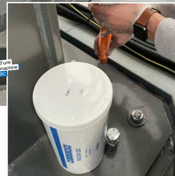
Réparation d'une embase de machine WEICON CBC
